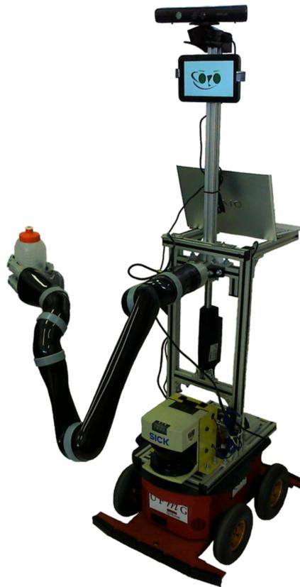
Figura 2.5: MARIA - *Manipulator Robot for Interaction and Assistance*, robô utilizado no grupo de pesquisa MACRO.
